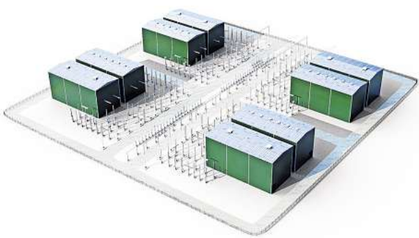
Schematische Grafik: Die ersten Multiterminal-Hubs, die in Norddeutschland entstehen, bestehen neben der DC-Schaltanlage aus einem Konverter und einem Umspannwerk.
