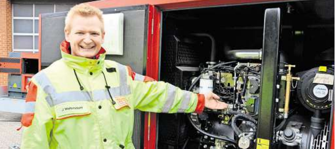
Bereit für den Notfall: Justin Waltersdorff zeigt das Innenleben eines mobilen Notstromaggregates. FOTO: FRANK HERMANN
