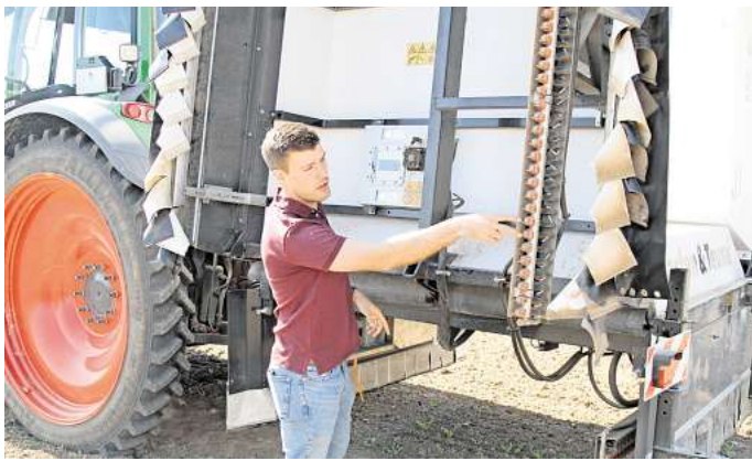
So funktioniert es: Gerald Henjes zeigt in der aufgeklappten Vorrichtung auf die Düsen, aus denen das Pflanzenschutzmittel gesprüht wird. Im Hintergrund sind Monitor und Kamera zu sehen. FOTO: STEPHAN HARTUNG
