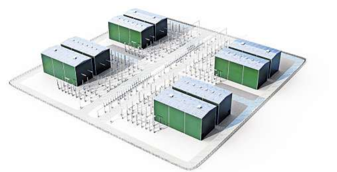
Schematische Grafik: Die ersten Multiterminal-Hubs, die in Norddeutschland entstehen, bestehen neben der DC-Schaltanlage aus einem Konverter und einem Umspannwerk.
